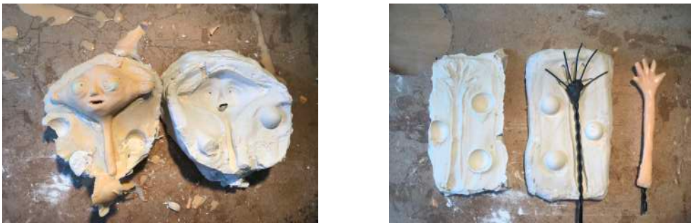
FIGURE 8 et 9 : le silicone catalysé tout juste démoulé, pour la tête de Polly, et un bras.
